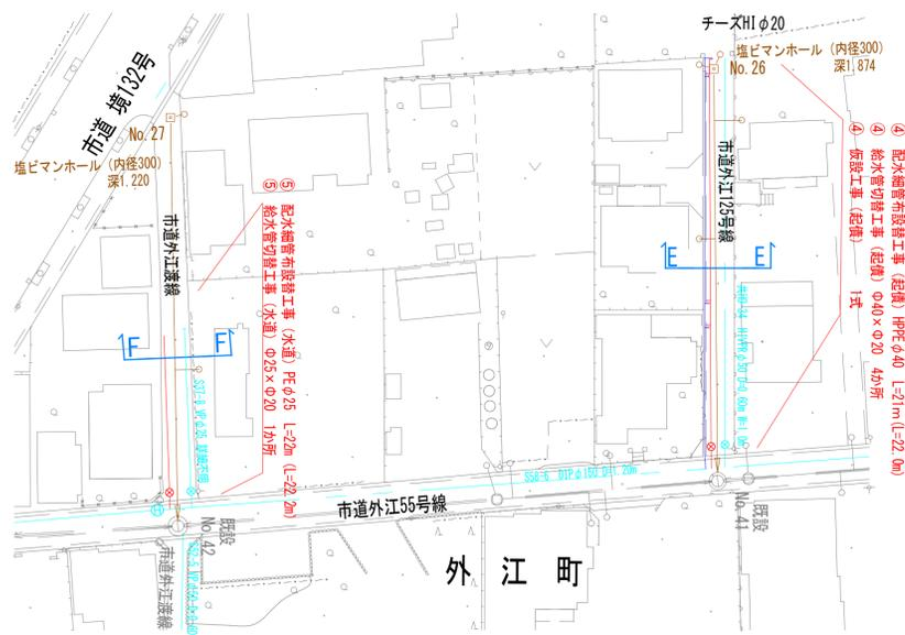
③ 配水細管布設替工事 (起債) HPPEφ40 L=15m (L=15.6m)
