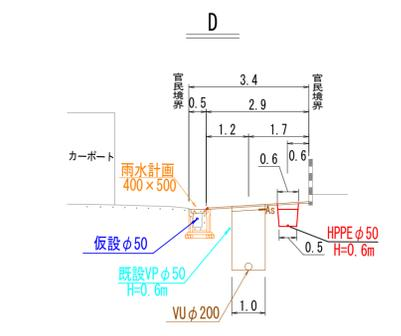
① 配水管布設替工事 (起債) HPPEφ50 L=188m (L=189.4m)
