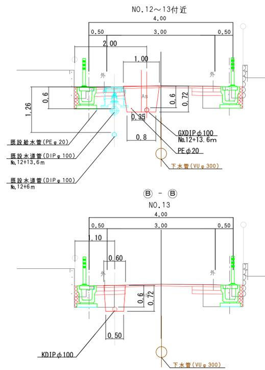
管渠工断面図 S=1:50
