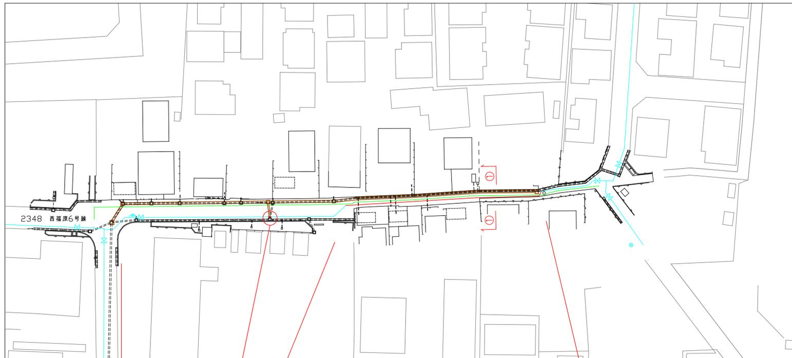
①配水管布設替工事(土木) HPPEφ50 L=54m(55.6m)
