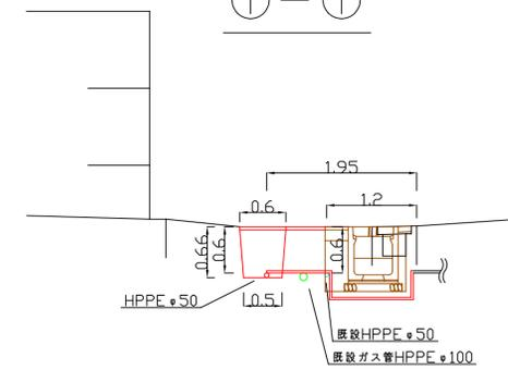
②配水管切替工事 縦断面 S=1:50
