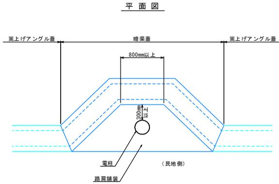
※電柱迂回部のかんたん側溝は短辺長800mm以上とし、電柱との離隔は300mm以上を確保すること。
