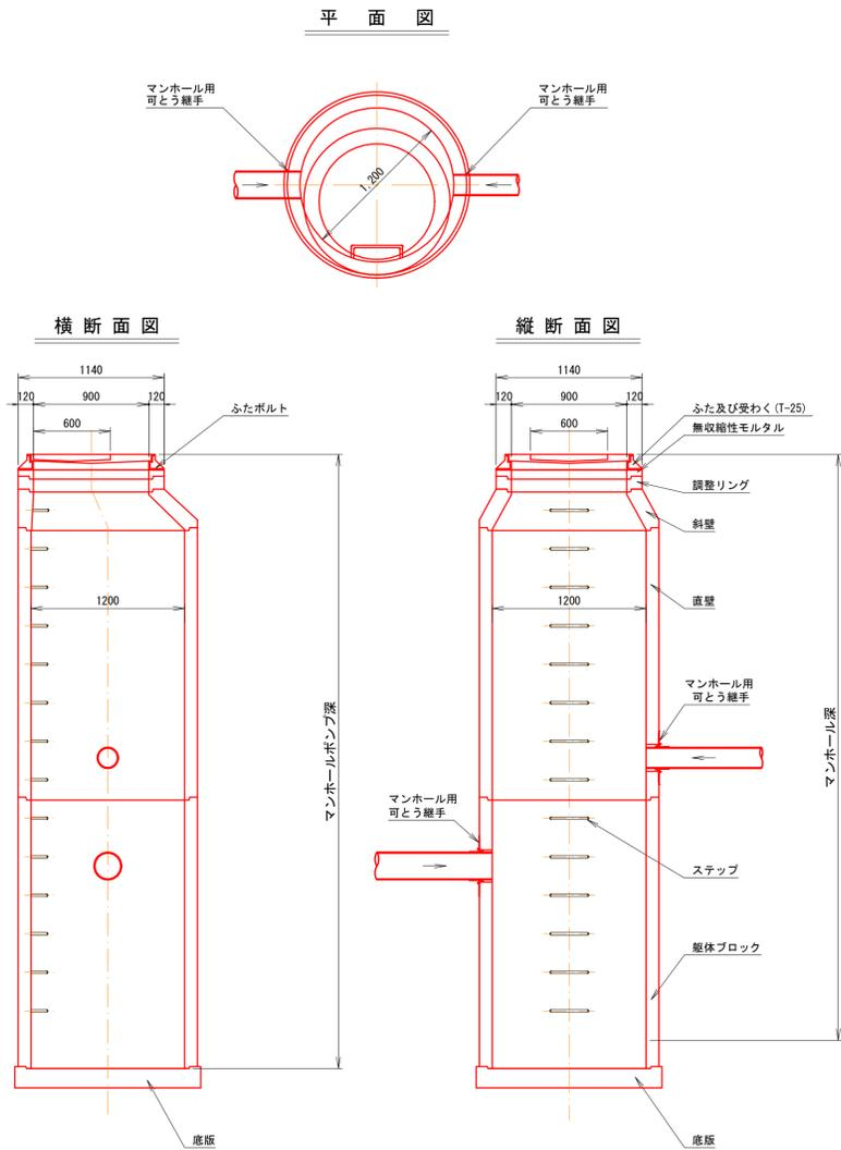
組立1号マンホール(内径90)標準構造図 縮尺 S=1:20
