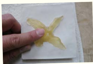
シリコン型に樹脂粘土を詰めて成型
