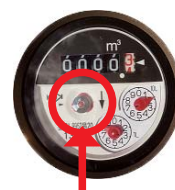
水道メーターの パイロット
