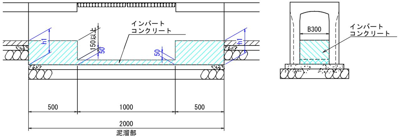
泥溜部のインバートコンクリートは、下式により算出している。
