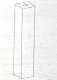
道路位置標識
