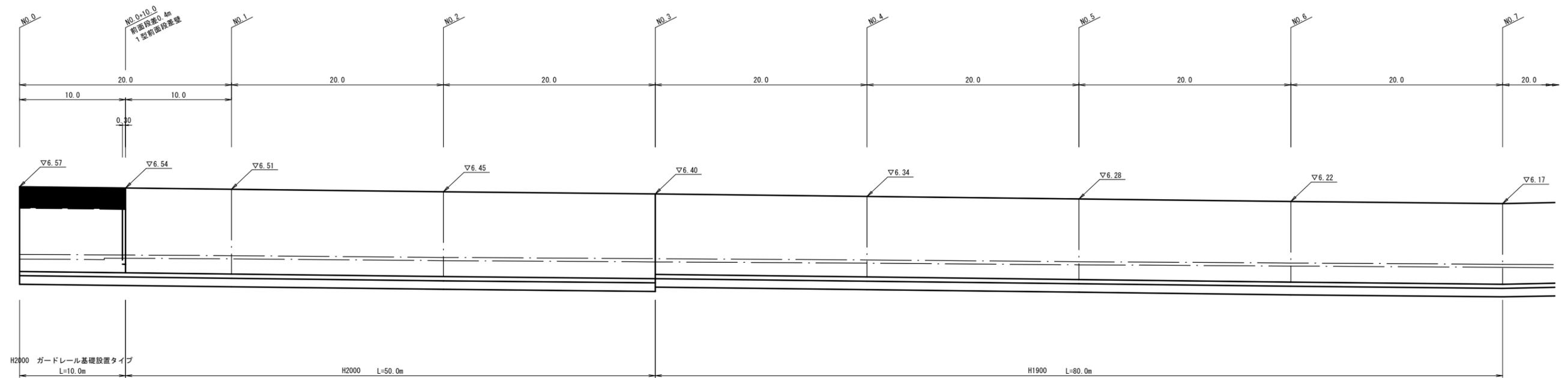
L型擁壁・重力式擁壁展開図 (NO. 9+18.7~NO. 11+2.3) 左側 HS=1:100
