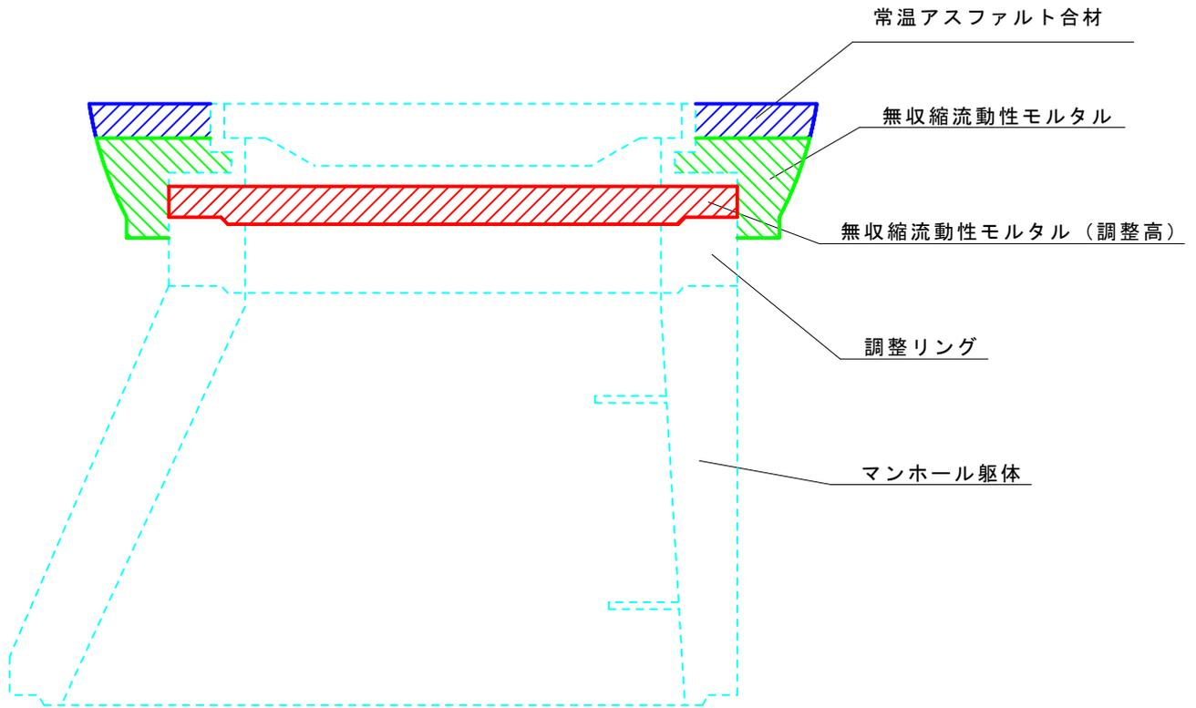
舗装復旧断面図 縮尺 1/20
