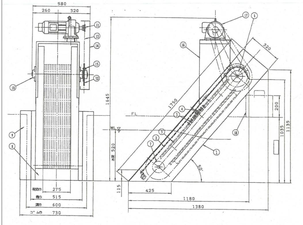
自動スクリーン(5.0mm目幅) 既設(参考図面)
