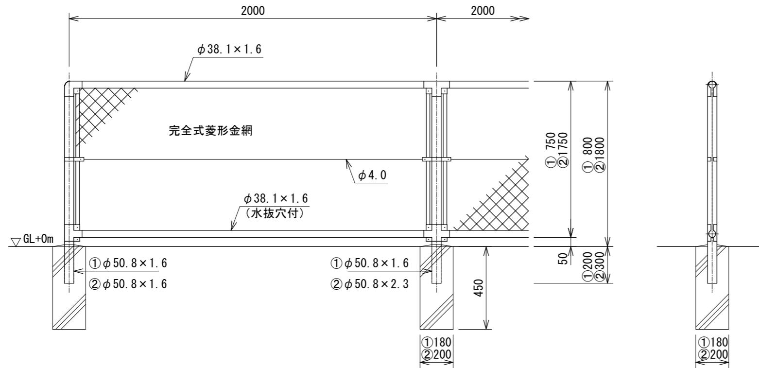
洞縁に金網取付断面図 S=1:3
