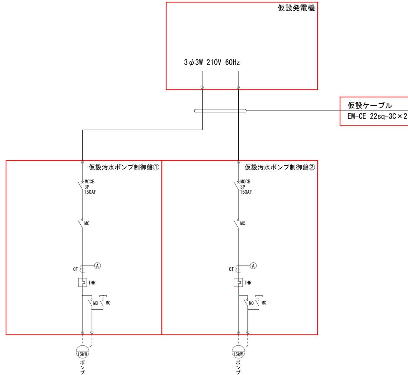
汚水ポンプ制御盤単線結線図(仮設)
