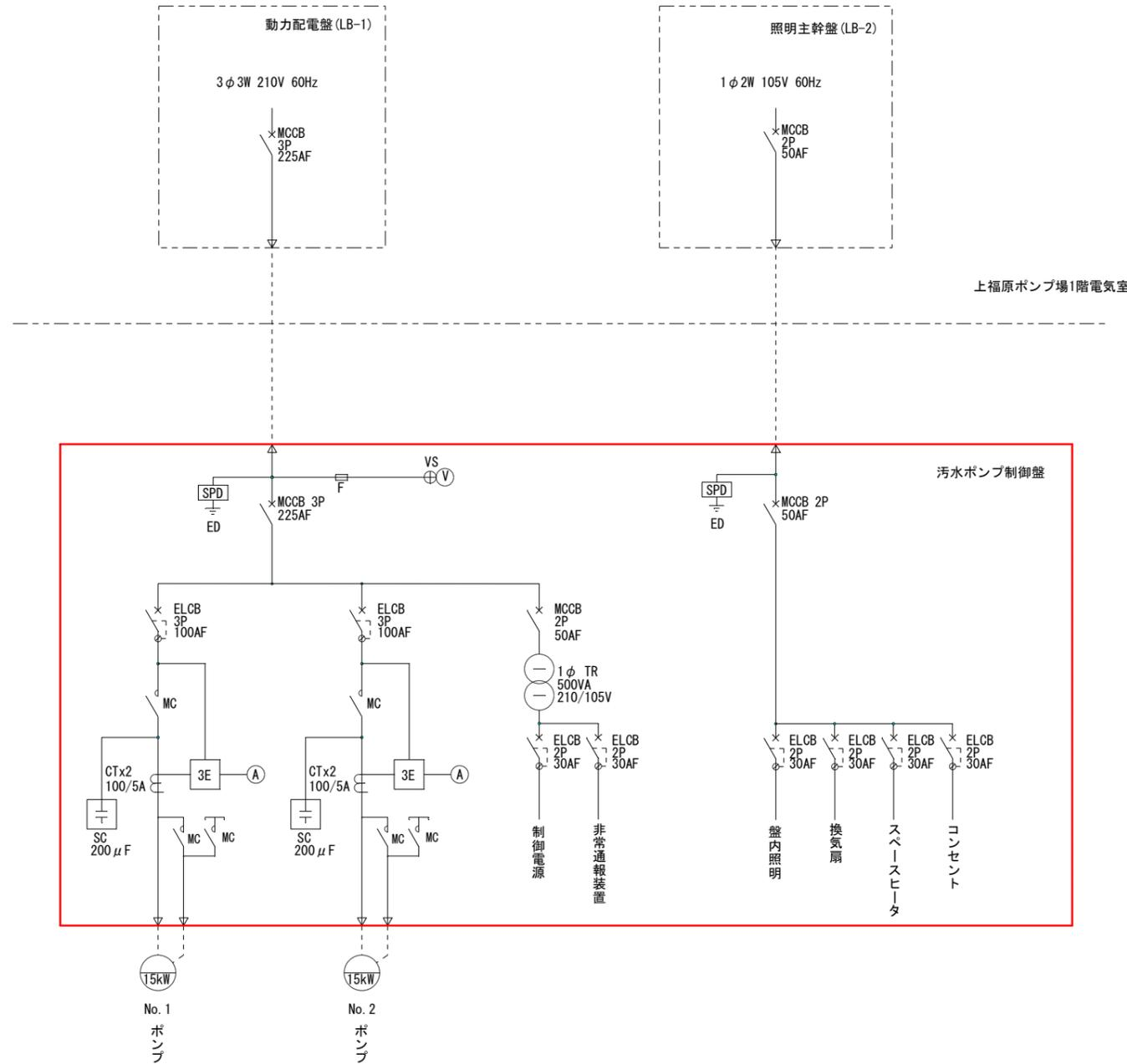
汚水ポンプ制御盤単線結線図(更新)
