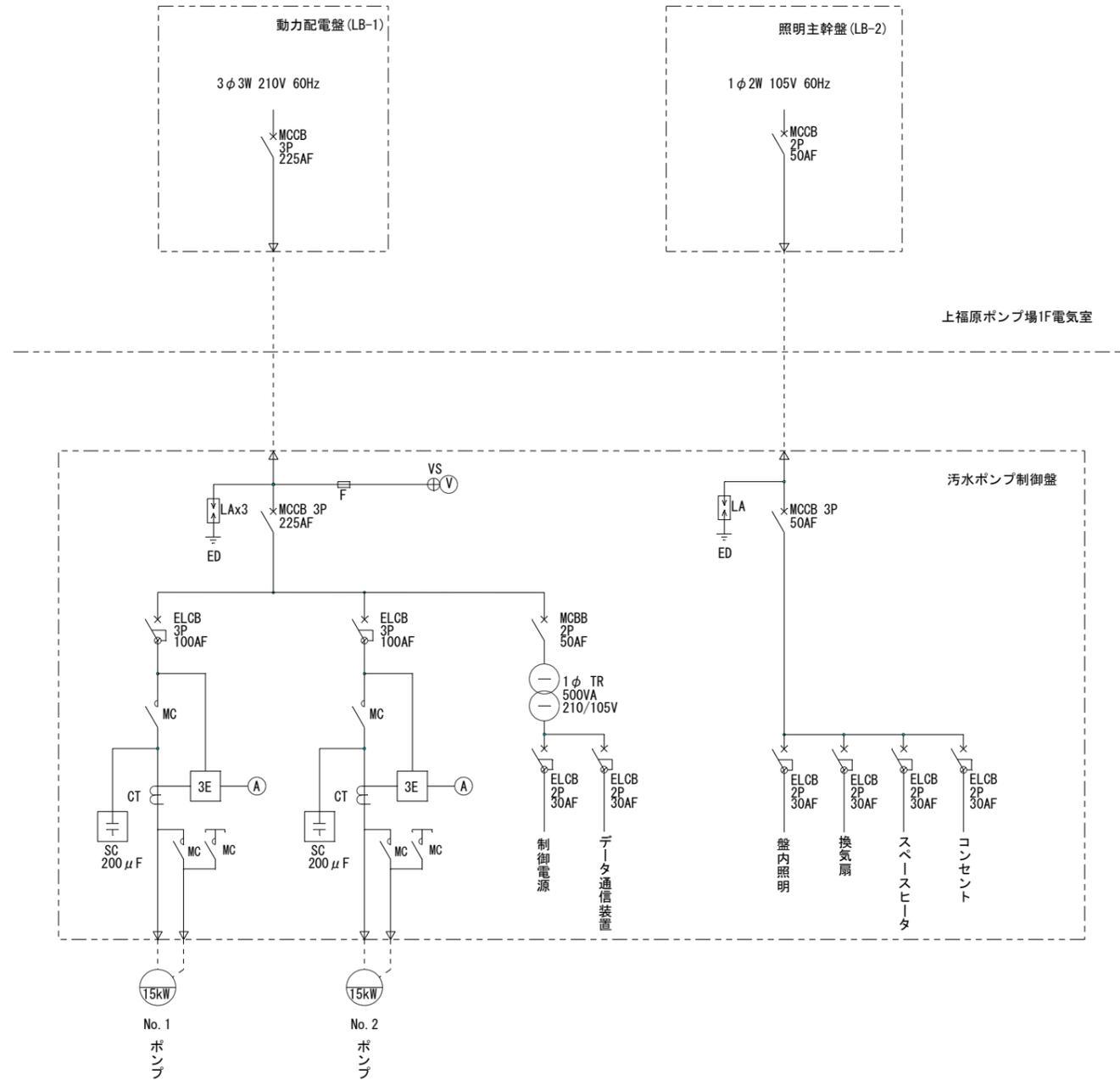
汚水ポンプ制御盤単線結線図(既設)
