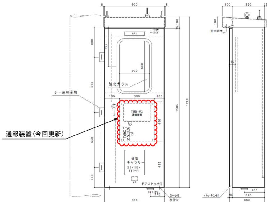
マンホールポンプ制御盤 機器配置図
