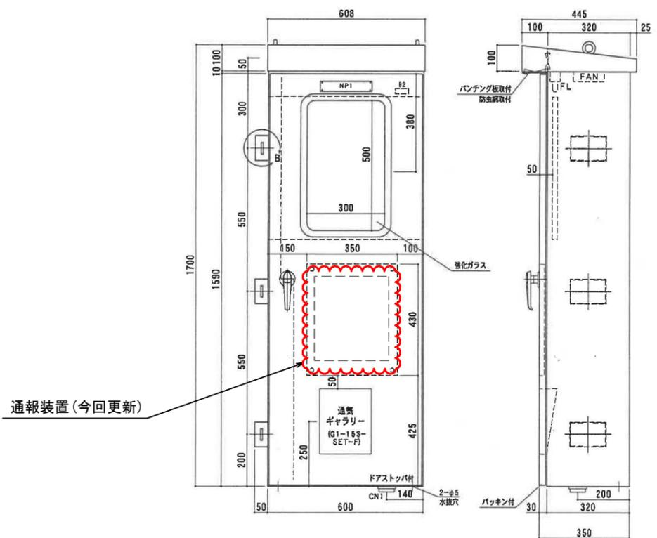
マンホールポンプ制御盤 機器配置図
