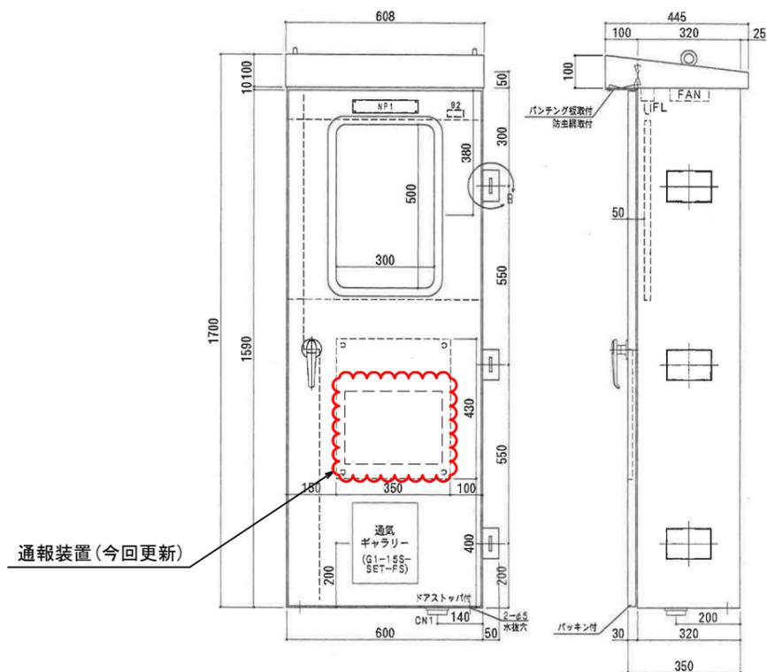
マンホールポンプ制御盤 機器配置図
