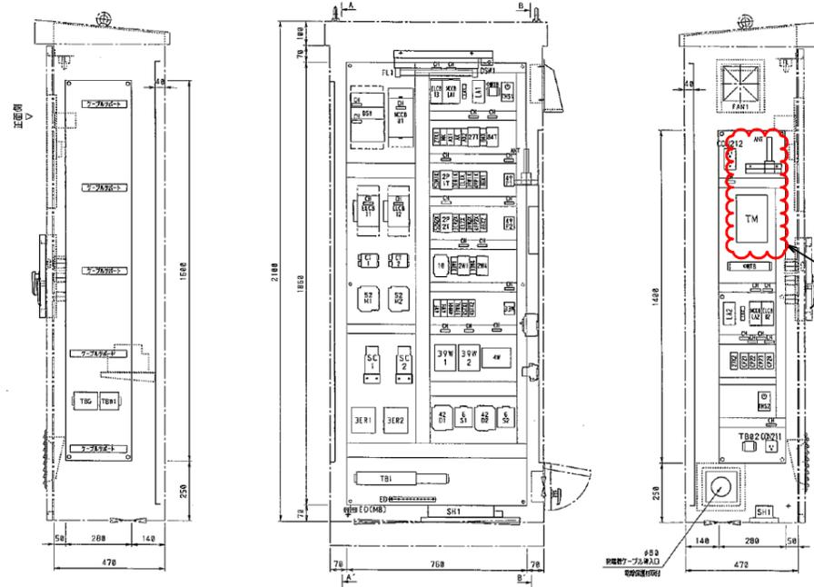
マンホールポンプ制御盤 機器配置図
