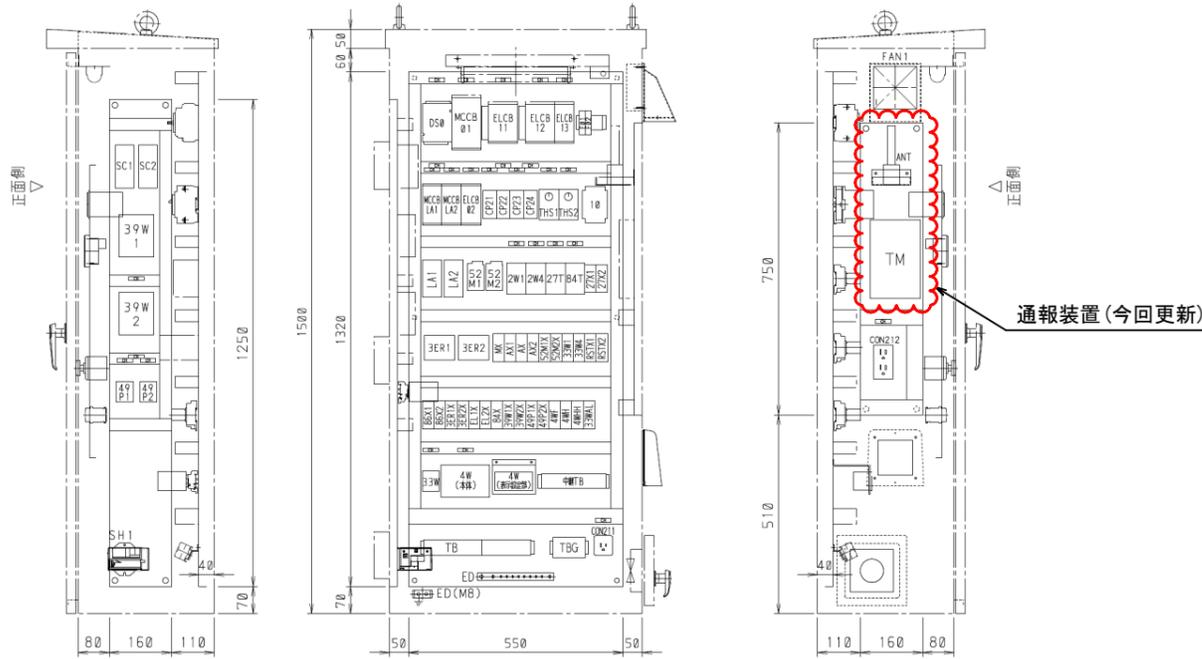
マンホールポンプ制御盤 機器配置図
