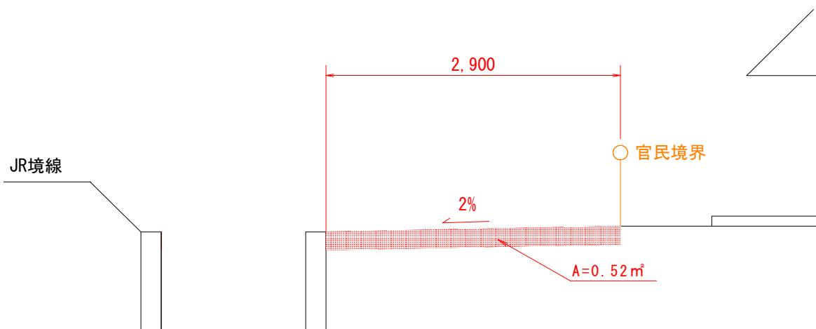
施工箇所(1) No.2、No.2+5.0掘削断面積
