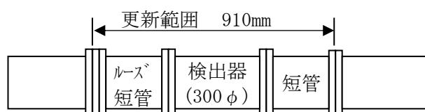
材質 発信器測定管 SUS304/316、相当品
