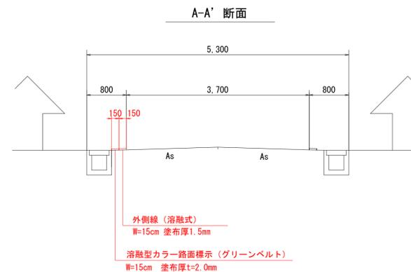
溶融型カラー路面標示 (グリーンベルト) 施工延長L=561m
