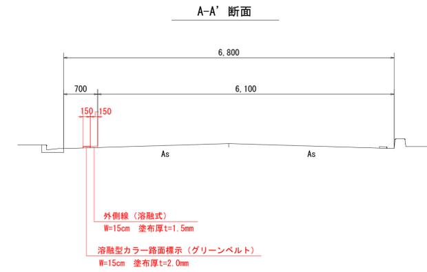
溶融型カラー路面標示 (グリーンベルト) 施工延長L=95m
