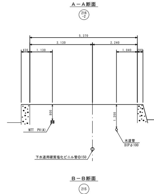
舗装撤去復旧工図 縮尺 1:10
