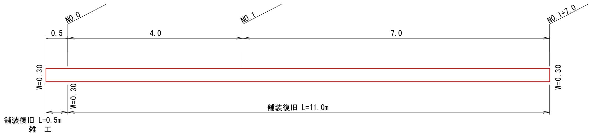
・表層(再生密粒度アスコン)  $t=5\text{cm} A=0.30 \times 11.5=3.5\text{m}^2$
