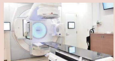
IMRTなど高精度放射線治療を行う治療機器「リニアック」
