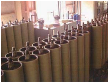
逆浸透法による高度水処理装置
