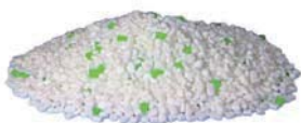
ペットボトルを破碎して作られるフレック（リサイクル製品の原料）
