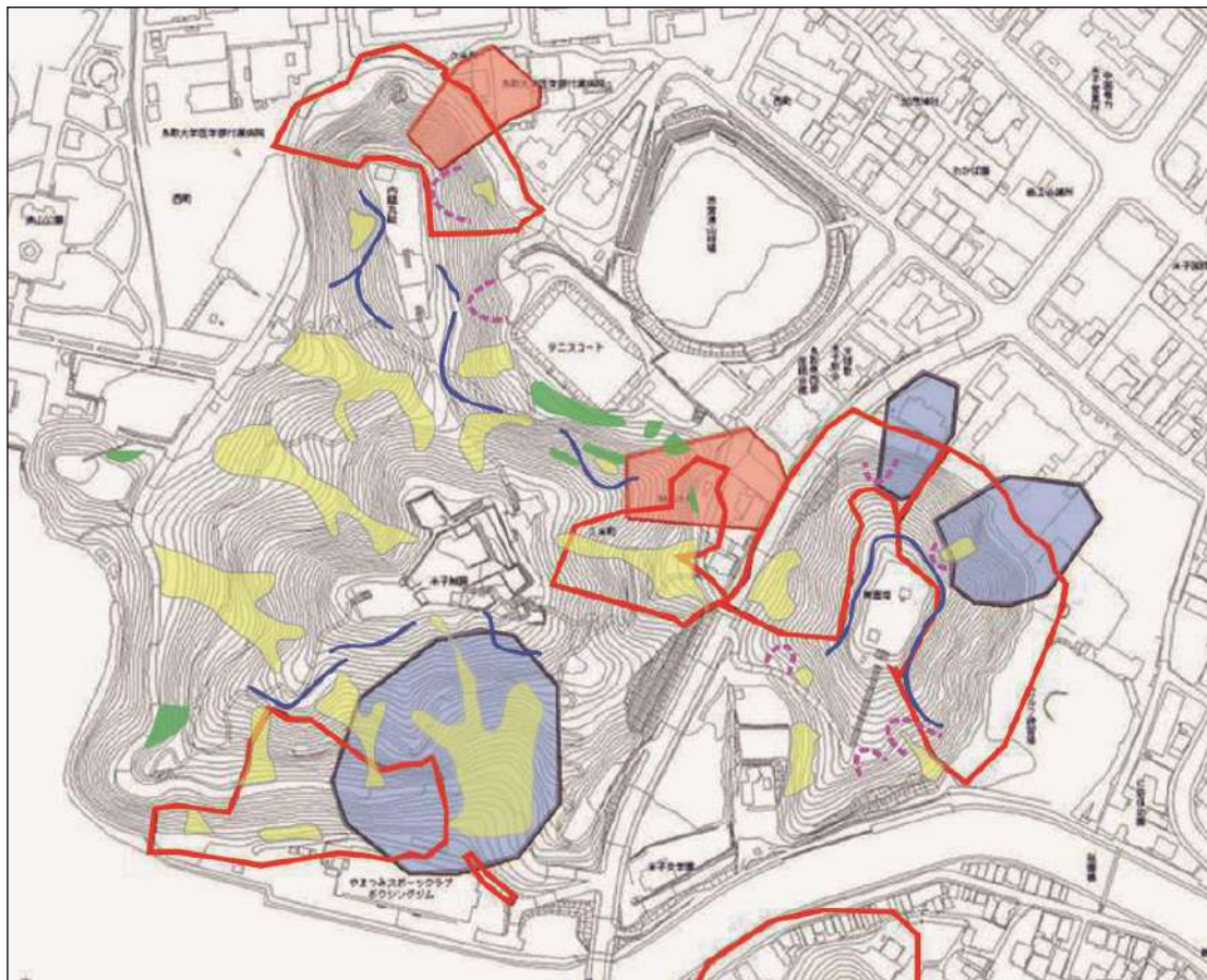
斜面の不安定箇所
