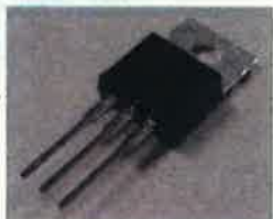
エネルギー消費を大幅に削減できる窒化ガリウムデバイス（環境省HPより）
